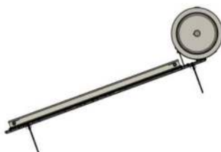
A series Struttura con supporti distanziati M12x350 mm
