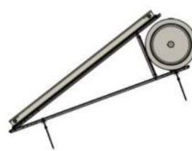
EVO series Struttura con supporti distanziati M12 X 350 mm
